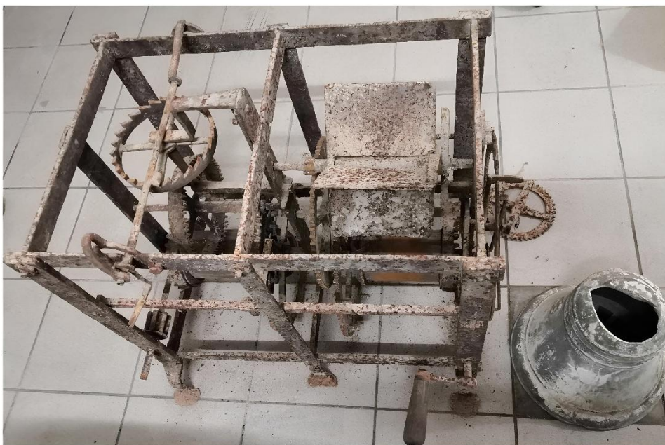
Fig. 4 – La campana rotta e l'orologio prima del restauro. Visibili lo scappamento a verga , la corona caterina e le altre parti meccaniche, foto di M. Mattia
